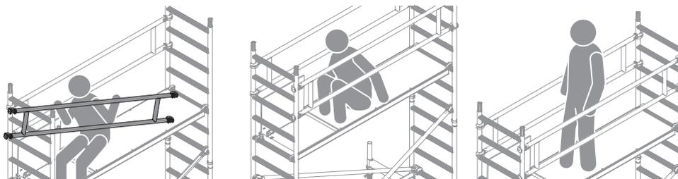
8. Beide Geländer unter der obersten Sprosse von innen einsetzen und verriegeln.
