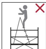
29. Es ist verboten, die Plattformhöhe durch Verwendung von Leitern, Kisten oder anderen Vorrichtungen zu vergrößern.
