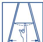
Spreizsicherung (zugfeste Verbindung)
